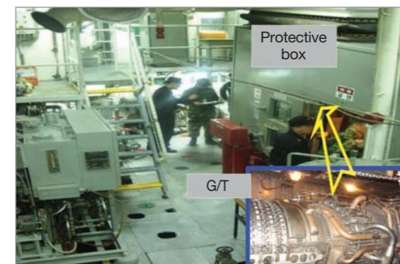
〈Figure II-2-9〉 Gas turbine protective box
